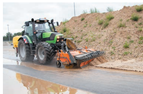
bema 75 Dual PowerMaster mit Aufkratzvorrichtung anstatt Schmutzsammelwanne (siehe Seite 58/59)
